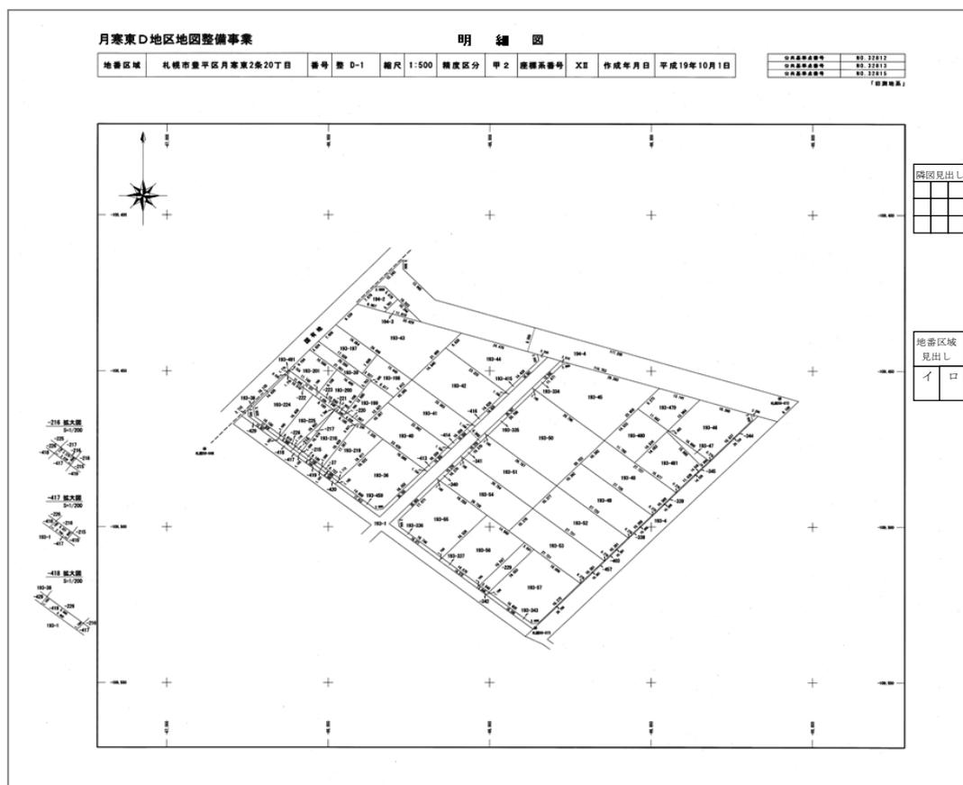
(座標軸と図郭の方向を合わせ、街区単位で作図した例)
