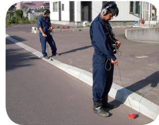
水をむだにしないように、地下にある水道管<sup>かん</sup>から、水もれがしていないか音を聴いて調べています。
