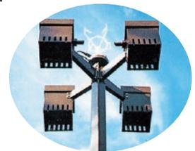
気象庁の観測データや、市内および周辺市町に約50か所せつち置されているマルチセンサーを使って、気温、風向や雪雲などを調べて、除雪作業の支援や、ロードヒーティングのコントロールなどに役立てています。
