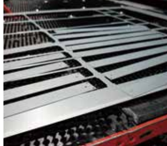
ターレットパンチプレスによる打ち抜き
