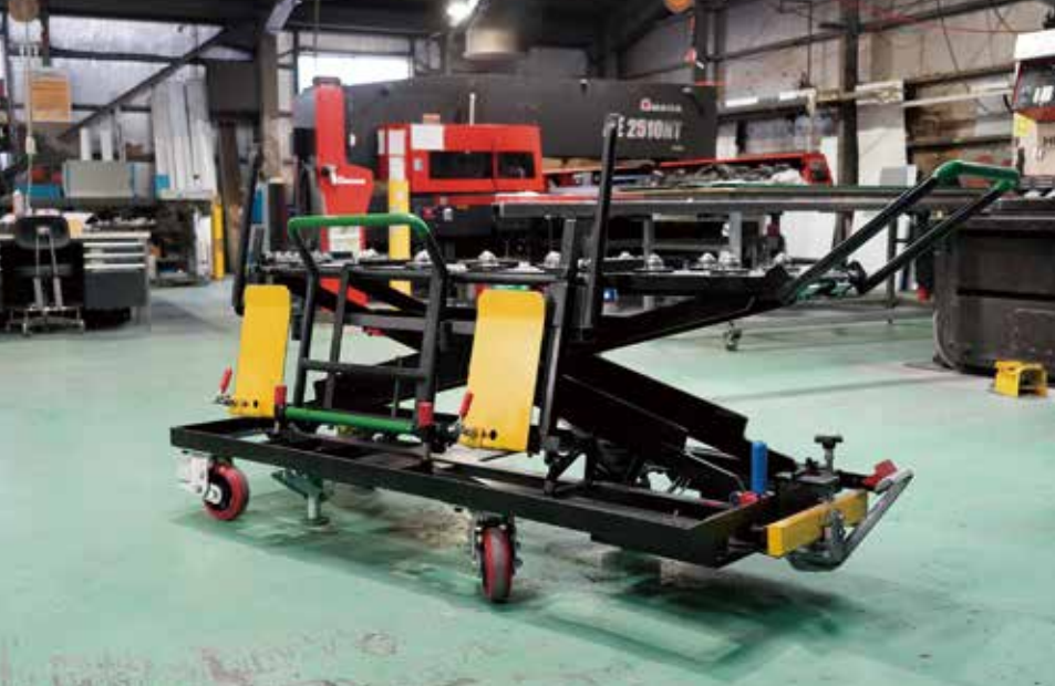
鋼板移動用台車。明るいカラーリングにもこだわった
