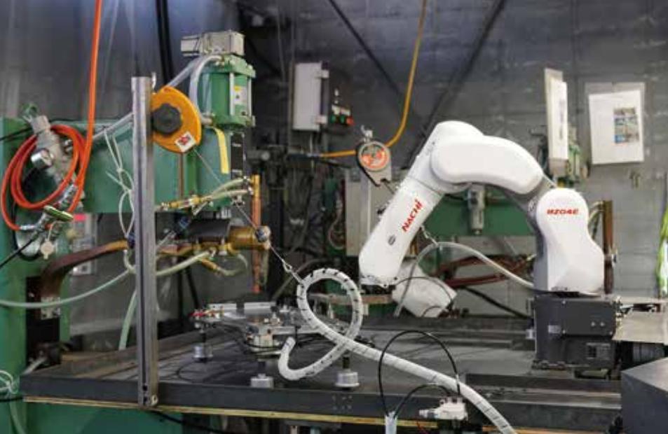
ハンドリングロボットがスポット自動溶接を行う様子。
