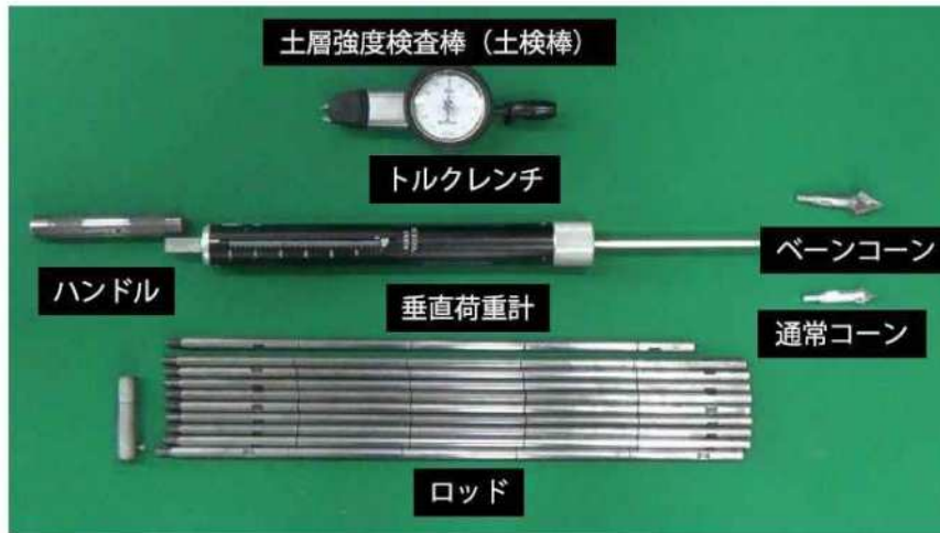
土層強度検査棒 (どけん棒) の構成
