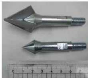
土層強度検査棒 (どけん棒) の構成
