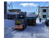
R6試験施工(小型ロータリ除雪車)
