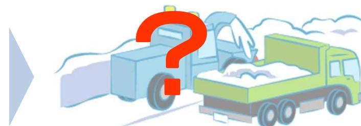
雪をダンプトラックに積み込む作業に、通常は歩道除雪などにのみ使用している**小型ロータリ除雪車**を活用
