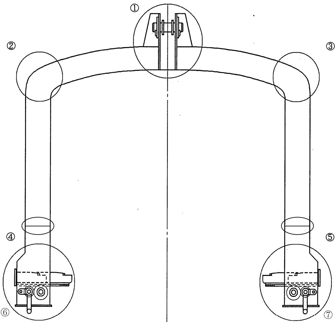
検査箇所について、別紙の検査項目に従い、分解及び塗装除去後に磁粉探傷試験または浸透探傷試験を実施し、検査終了後に塗装を行なうこと。
