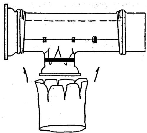
g 枝管（呼び径d）用スリーブをゴムバンドで管を固定する。
