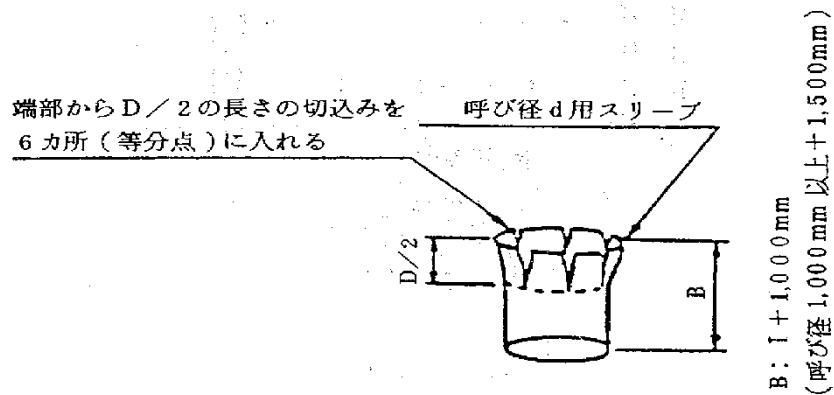
d 本管(呼び径D)用スリーブを管に挿入し、広げる。
