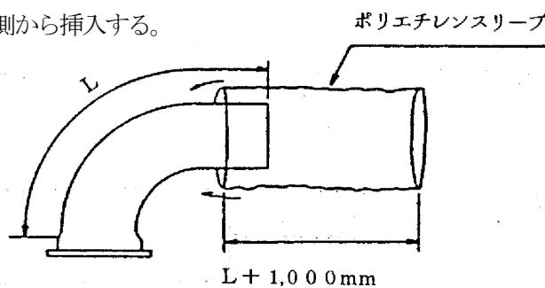
b 插入されたスリーブを管全体に移動させ、形を整える。
