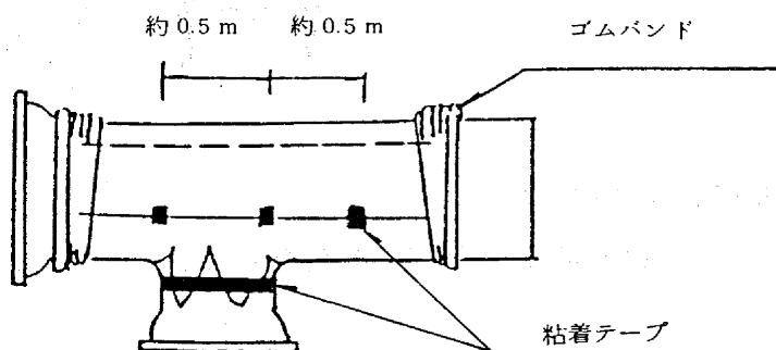
また、本管(呼び径D)用スリーブの枝管部分まで切り目を入れた箇所は、粘着テープを用いて完全にシールする。
