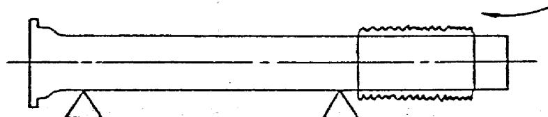
d 挿し口部を吊り、中央部の管台を挿し口側に戻し、スリーブを直管全体に広げる。
