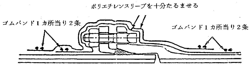
図-3 傾斜配管におけるスリープの施工方法
