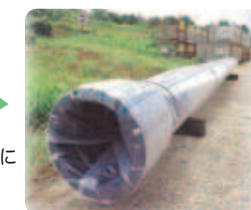
腐食対策を施した管
